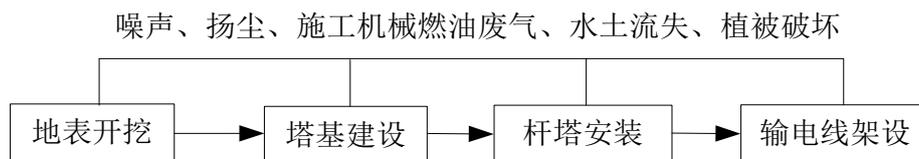
图 4-5 架空输电线路施工工艺流程及产污环节图
