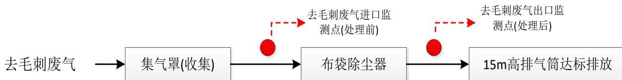
图 3-1 去毛刺废气处理流程图
